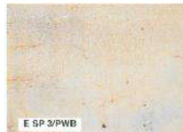
Estándar visual SSPC VIS 3. Grado inicial (pintura en la superficie) y Grados de limpieza esperado SSPC SP 2 y SSPC SP 3 (utilizando carda como herramienta)
